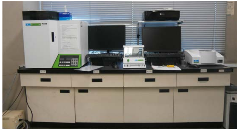
元素分析装置(PerkinElmer 2400 II CHN)・左 熱分析装置(PerkinElmer TGA 4000)・右
